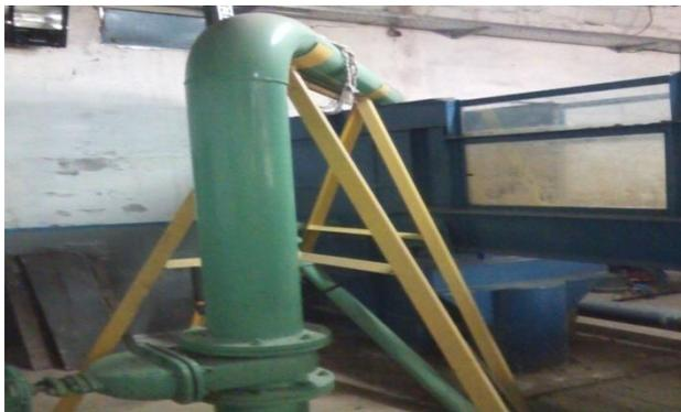
Figura 23 – Cañería de alimentación al canal experimental
