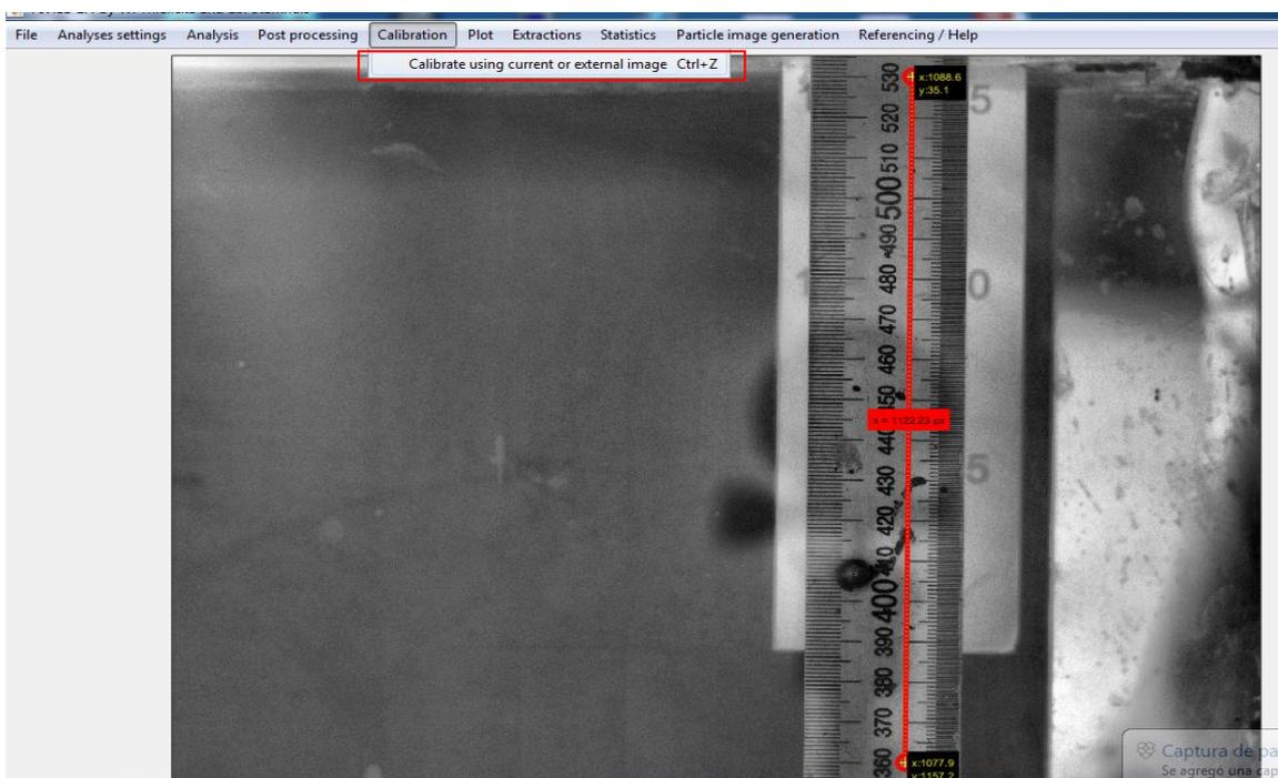
Figura 85 – Calibración de imágenes en PIVLAB
