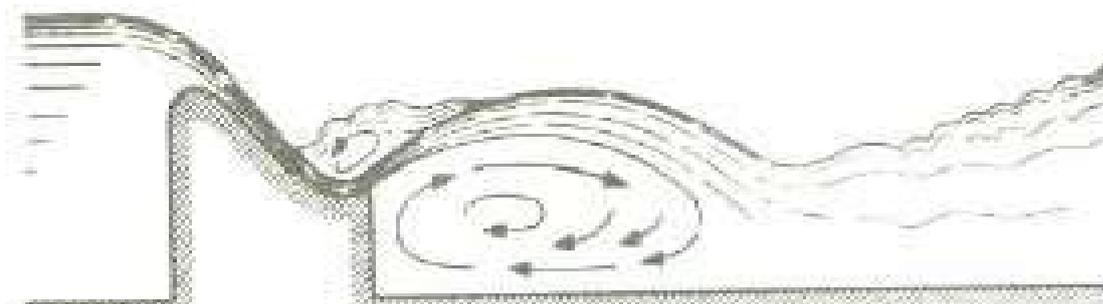
Figura 17 – Caso 3: Funcionamiento del Salto Esquí
