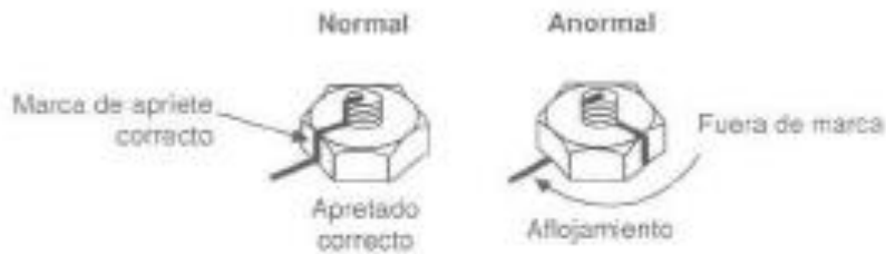
Marcar para apriete correcto de tuercas y pernos
