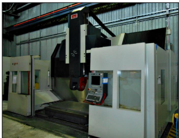
Figura 2.2 – Centro de Mecanizado FIDIA K211
