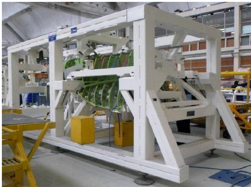
Figura 1.35 – Utillaje de armado de Conjunto fuselaje
