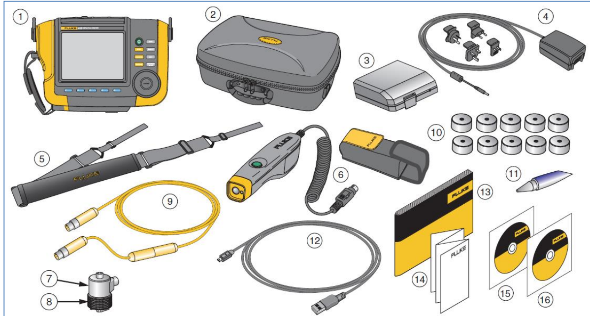
Figura 4.23 – Equipamiento del Analizador de Vibraciones Fluke 810
