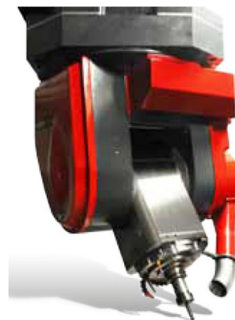
Figura 2.16 – Cabezal de Fresado FIDIA M5C. General Catalog: GTF line (2015)
