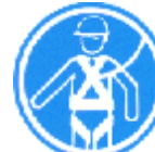
Protección individual obligatoria contra caídas
