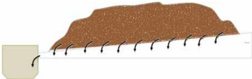
Figura 15 - Sistema de recolección de lixiviados
