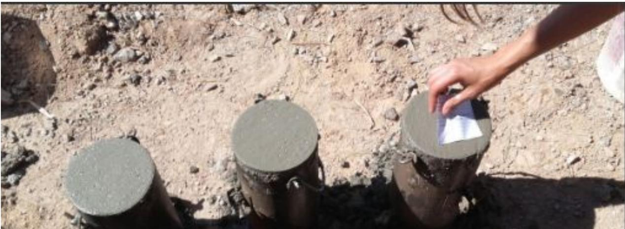
**FIGURA 35:** Identificación de las probetas en el pie de obra.
