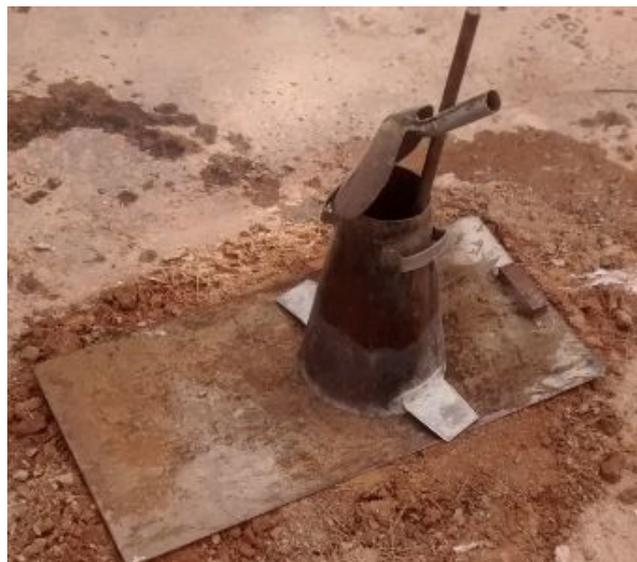
**FIGURA 14:** Elementos a utilizar para realizar en el ensayo de asentamiento.
