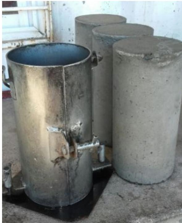
**FIGURA 38:** Desmolde de probetas en el laboratorio.
