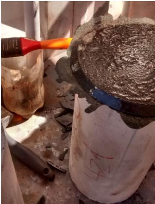
**FIGURA 43:** Cara superior encabezada con mortero de azufre.
