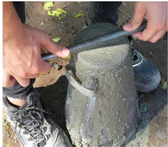
**FIGURA 25:** Enrasado con varilla metálica.
