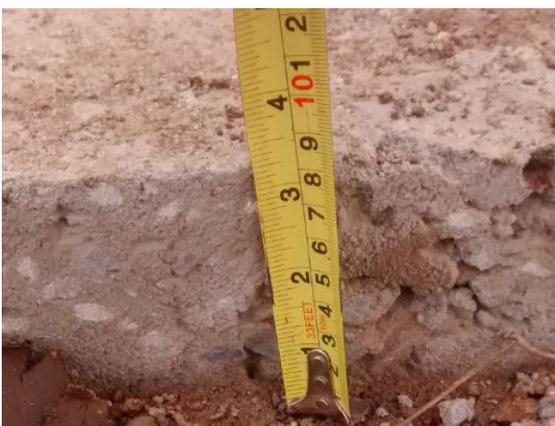
**FIGURA 205:** Espesor del paquete 8 cm.
