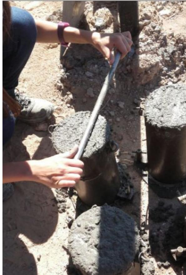
**FIGURA 34:** Enrase con varilla metálica.
