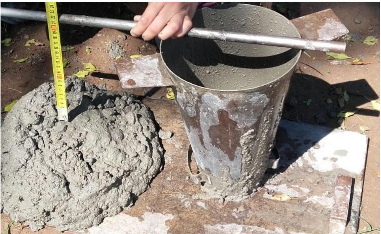
**FIGURA 27:** Medición del asentamiento.
