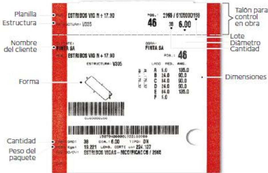
FIGURA 48: Identificación de cada paquete de armadura.
