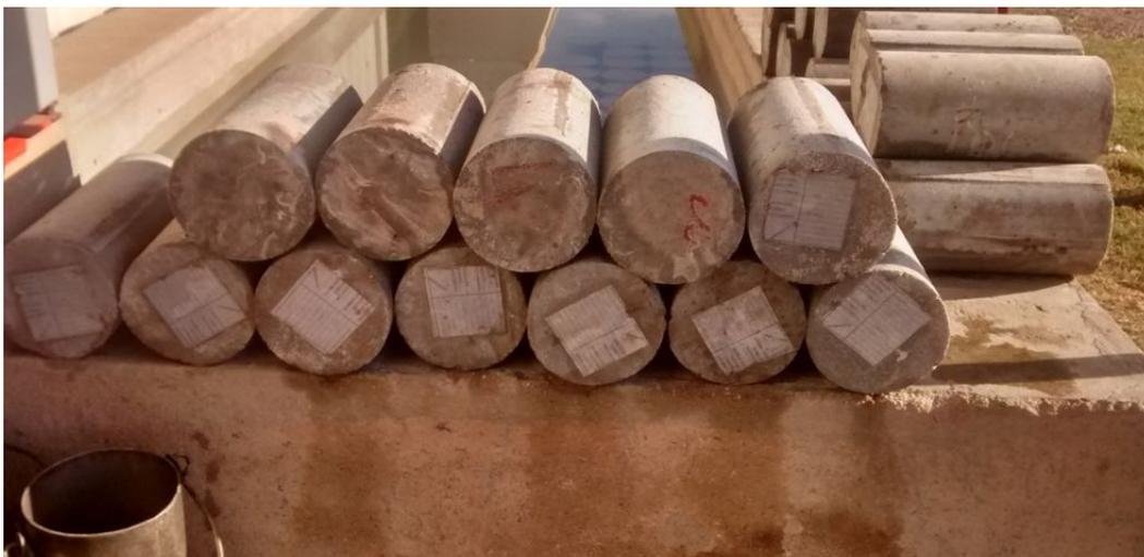
**FIGURA 40:** *Probetas luego de 28 días de curado.*
