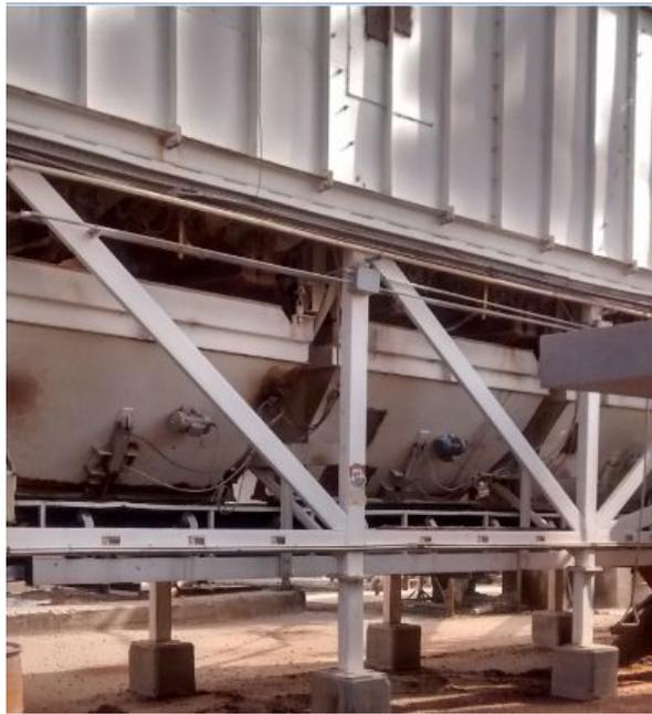
**FIGURA 8:** Planta de Hormiblock. Balanzas incorporadas en las tolvas.
