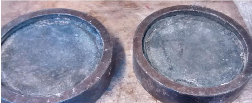
**FIGURA 46:** Discos metálicos y sobre ellos neopreno.
