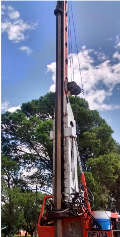
**FIGURA 70:** Mástil de la máquina pilotera.
