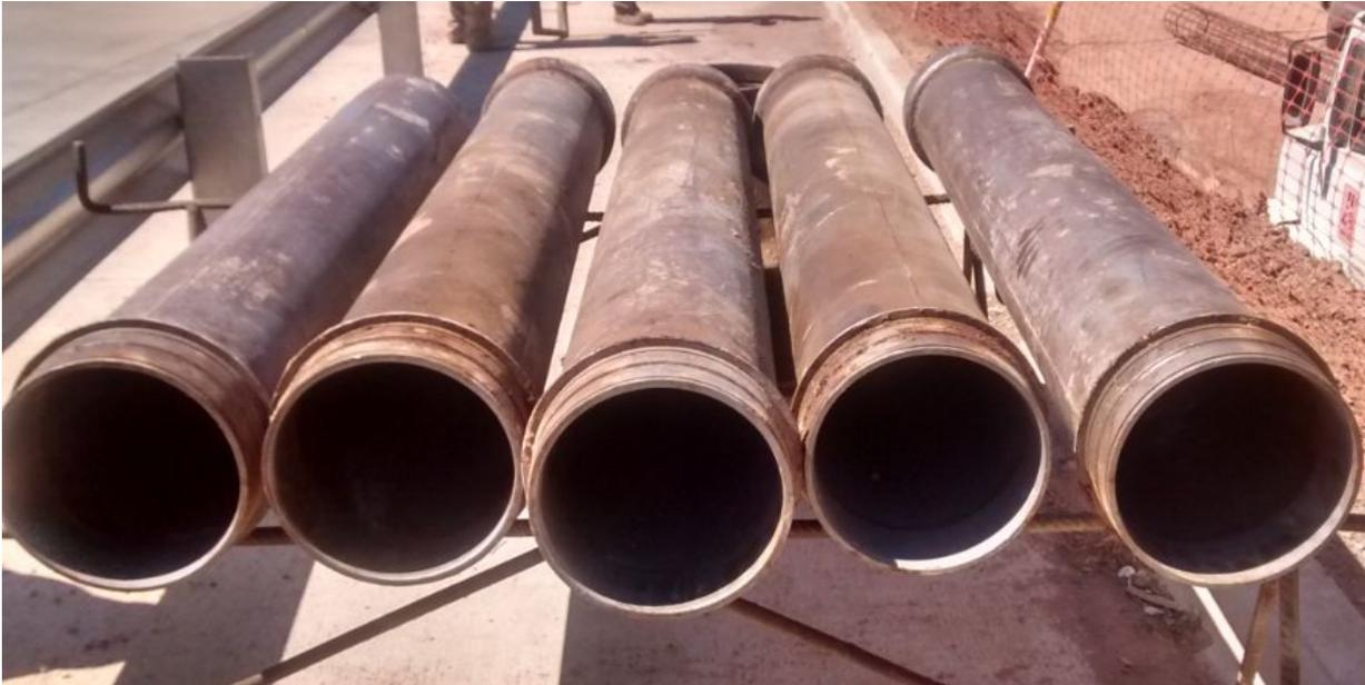
**FIGURA 79:** Tubos tremie para hormigonar.
