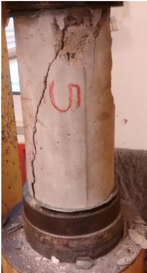
**FIGURA 47:** Rotura de la probeta.
