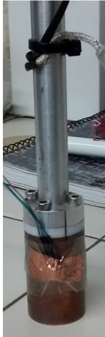
Figura 5.1: Dispositivo utilizado para el método transient hot-wire .
