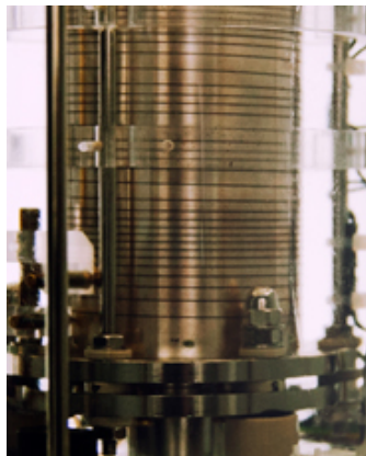
Figura 2.9: Imán tipo Schweikert mostrado con parte del montaje en un equipo comercial de la empresa Stelar. [8]
