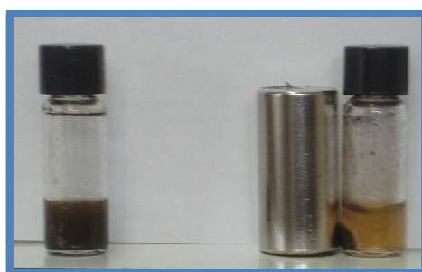
Figura 5.3: Ferrofluido F-M120 en presencia (derecha) y ausencia (izquierda) de campo magnético externo.
