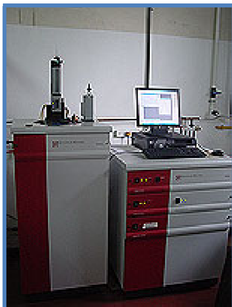
Figura 3.5: SQUID 7 T Quantum Design , Laboratorio de Bajas Temperaturas, UBA.
