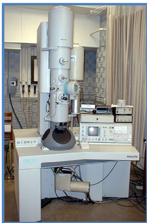
Figura 3.3: Microscopio electrónico de transmisión de alta resolución Philips CM200-FEG TEM/STEM .
