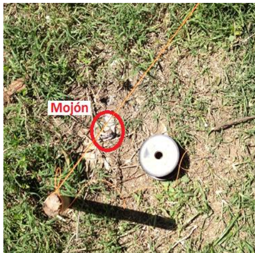
Figura 14: Estaca y mojón suroeste
