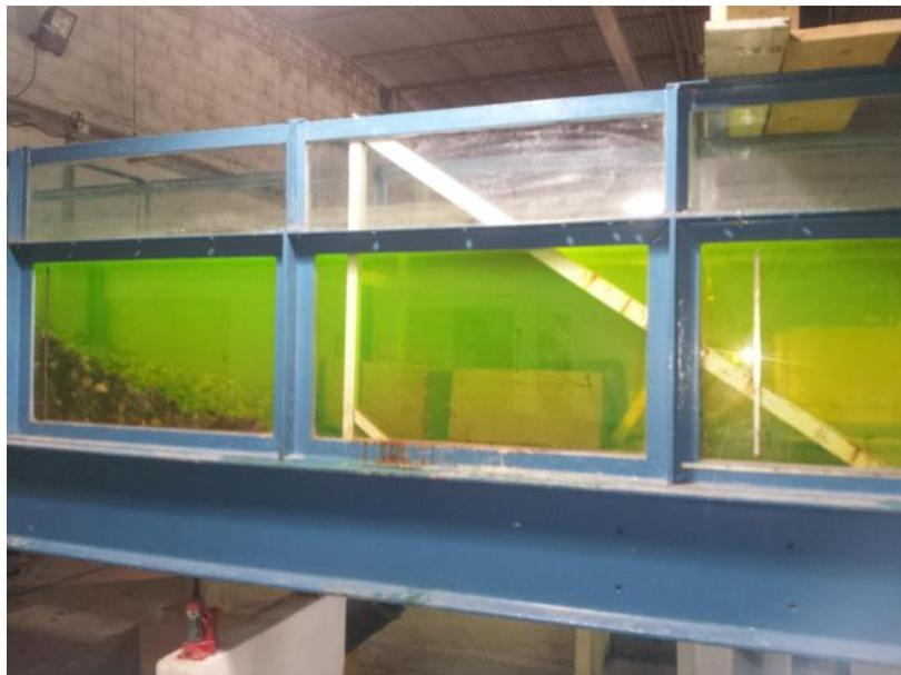
Figura 27. Estructura usada en modelo físico de la represa.
