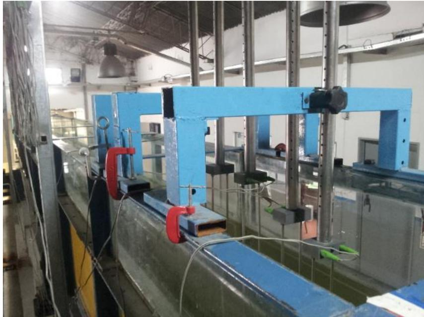
Figura 28. Sensores de nivel de tipo resistivo para medir la altura de ola y separar la señal incidente y reflejada.
