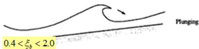
Figura 19. Tipo de rotura Plunging.
