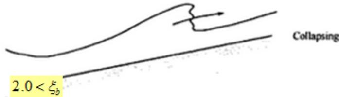
Figura 20. Tipo de rotura Collapsing.
