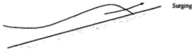
Figura 21. Tipo de rotura Surging.
