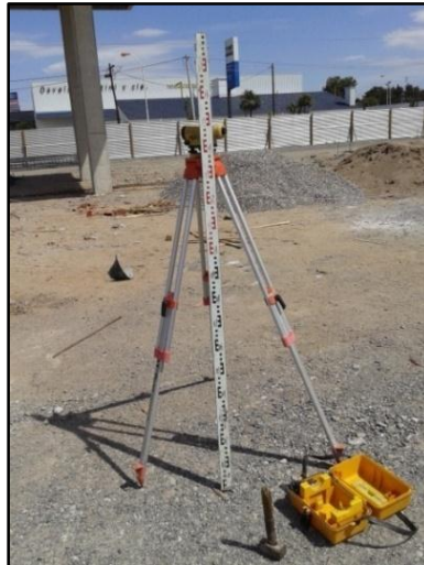
Figura N° 32: Nivel óptico y mira.
