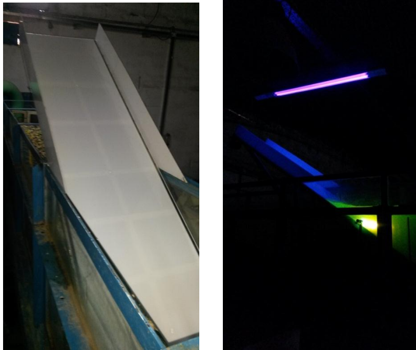
Figura 4-11 Estructura construida e instalada en el canal de oleaje e instantánea durante un ensayo
