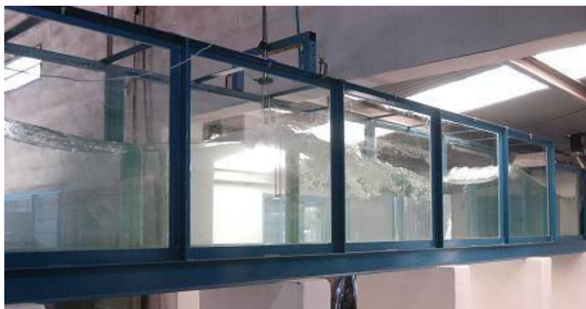
Figura 4-1 Canal de oleaje del Laboratorio de Hidráulica de la UNC.
