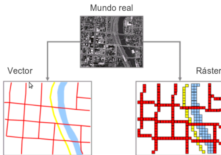
Figura 6: Representación del mundo real, en modo vectorial versus modo ráster. La primera está definida por líneas o vectores y la segunda se trata de retículas, celdas o grillas.
