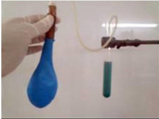
Figura VII.63. Diseño empleado para la simulación de la prueba de alcoholemia.
