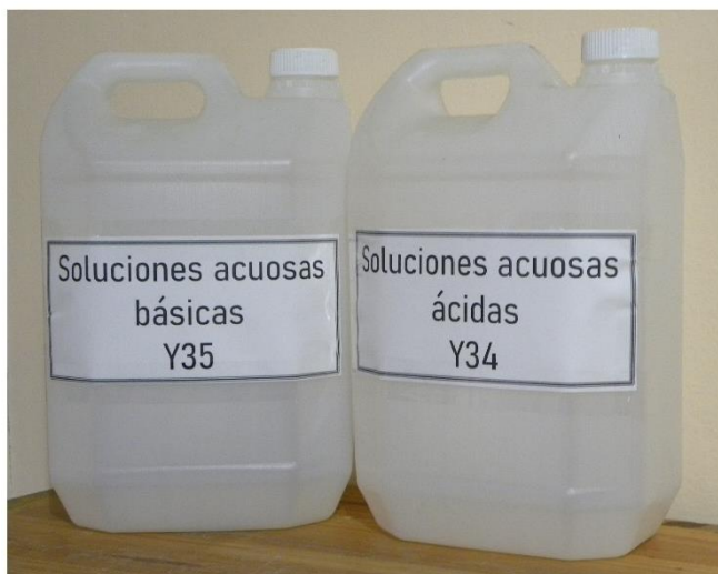
Figura I.5. Contenedores para productos químicos tóxicos de desecho. El rótulo indica la “corriente de desecho”, es decir el tipo de líquidos según la ley de residuos peligrosos. Área Centralizada de Actividades Prácticas, Facultad de Ciencias Químicas, UNC.
