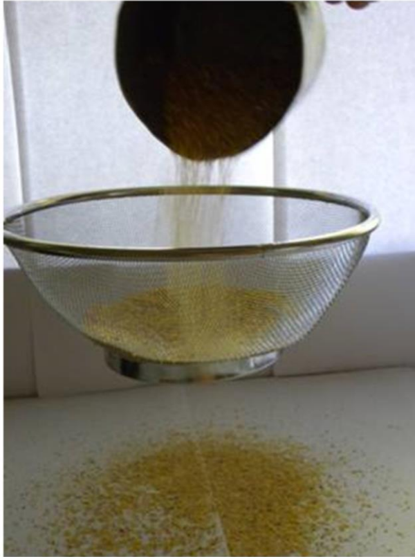
Figura V.1. El tamizado es uno de los procedimientos mecánicos más simples. Este colador permite separar partículas sólidas en dos grupos, según sean menores o mayores que el tamaño de la malla.
