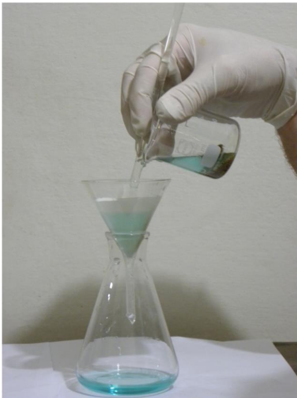
Figura V.2. La filtración. Permite separar partículas sólidas suspendidas en un líquido siempre que su tamaño supere el diámetro de los poros del filtro.
