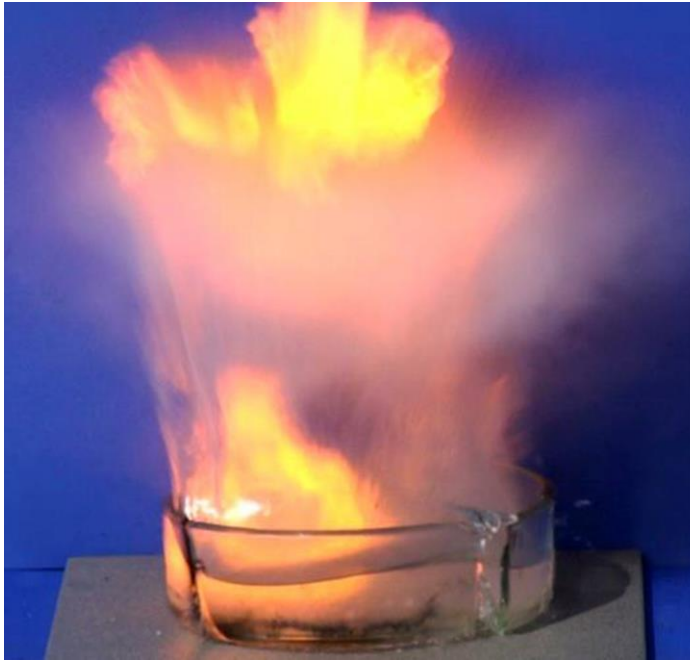
Figura VI.16. La reacción explosiva del sodio con el agua. El calor liberado ha roto el recipiente de vidrio.
