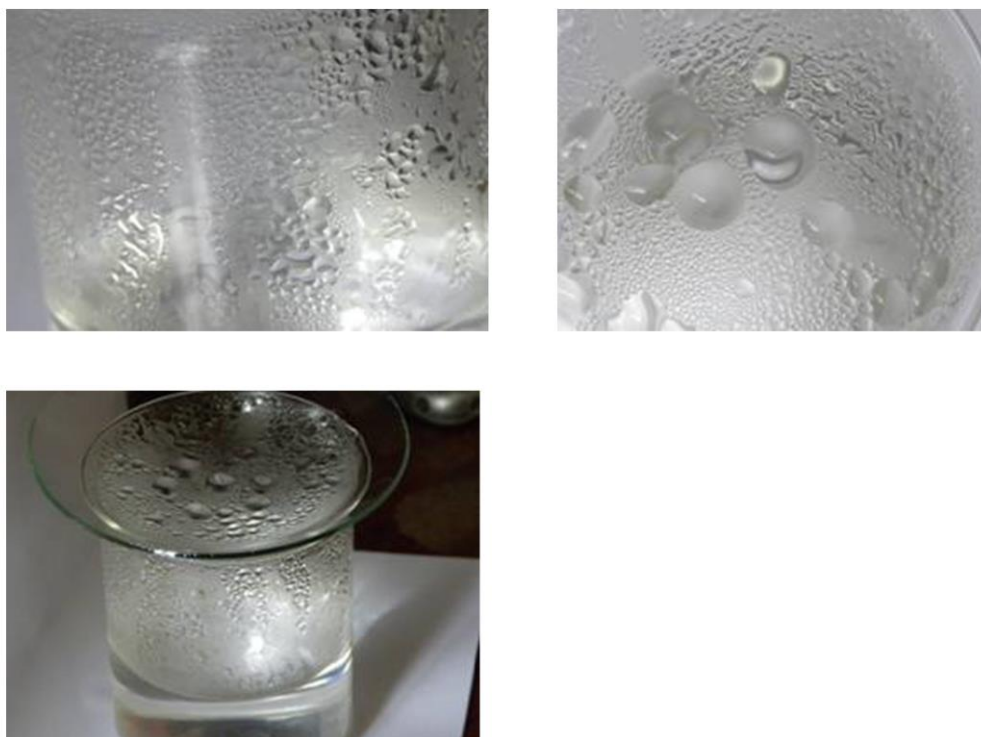
Figura V.8. Gotas de agua formadas por condensación del vapor. Estas gotas pueden considerarse de agua destilada.
