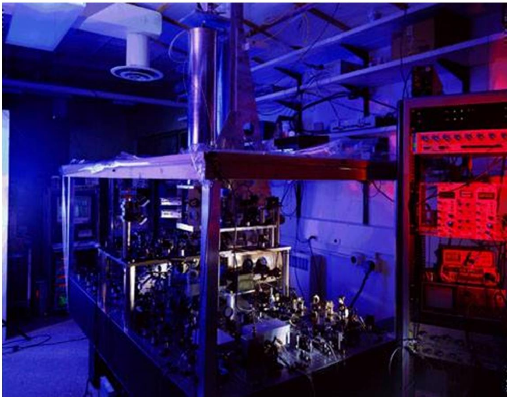
Figura II.4. Reloj atómico con fuente de cesio, que establece el estándar de tiempo y de frecuencia en EEUU, con una incerteza de 5 \times 10^{-16} . Año 2005.
