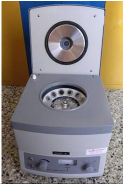
Figura V.5. Centrífuga destapada donde puede verse el rotor y los receptáculos para los tubos de centrifugado. Los botones del panel frontal, además del encendido y apagado, permiten regular la velocidad angular del rotor.
