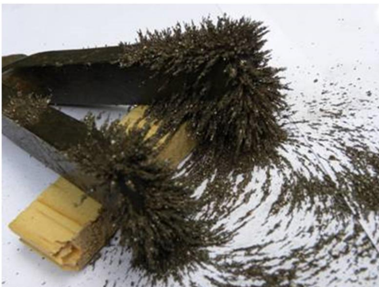
Figura V.6. Separación por efecto de un campo magnético. Las limaduras de hierro son colectadas por el imán. Observe sobre el papel la ubicación de las limaduras de hierro siguiendo las líneas del campo magnético.
