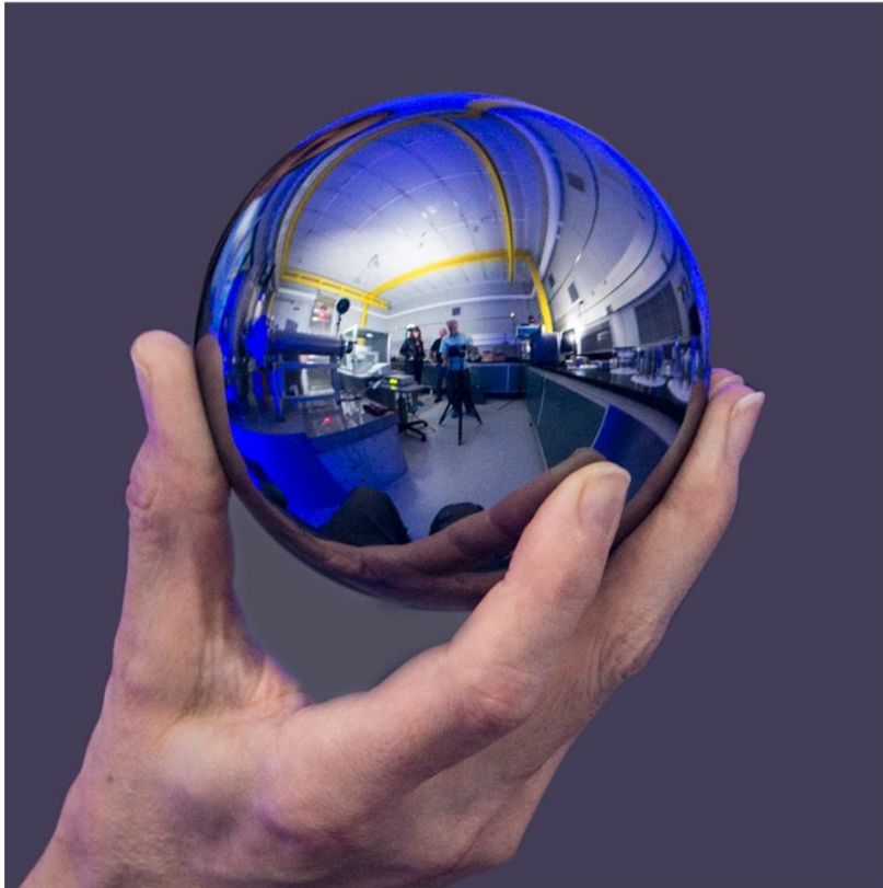
Figura II.8. Esfera de silicio, similar a las utilizadas en el proyecto Avogadro. La esfera, de 93,6 mm de diámetro, se talló a partir de un monocristal de silicio-28 puro al 99,9995% con una masa de 1 kg.
