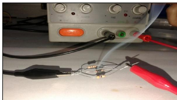
Fig. 5. Destrucción total de un resistor por sobre elevación de temperatura.
