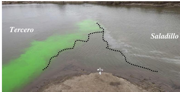
Figura 8: Visualización de la zona de estancamiento para la condición experimental 2.
