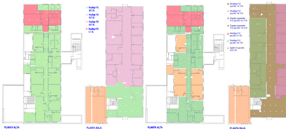
Figura 1. Configuración de equipos existentes.
