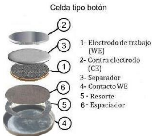
Figura 5.14: Ensamblado de la parte básica de la celda botón tradicional (3.3) con la cazoleta de contacto del CE en el lugar del WE (4), siguiendo en orden: 5)resorte, 6)espaciador, y la parte electroquímica: 1)electrodo de trabajo, 3)separador y 2) contraelectrodo.
