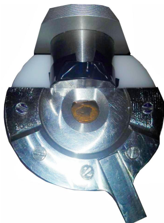
Figura 5.16: Montaje en el equipo PANalytical del primer diseño mecanizado modificado. La cara posterior de la Parte 1 entra en contacto con una parte metálica del equipo.
