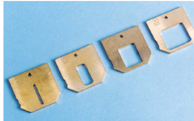
Figura 2.16: Máscaras para el haz emitido en el tubo. La del extremo izquierdo es la de 5^\circ .
