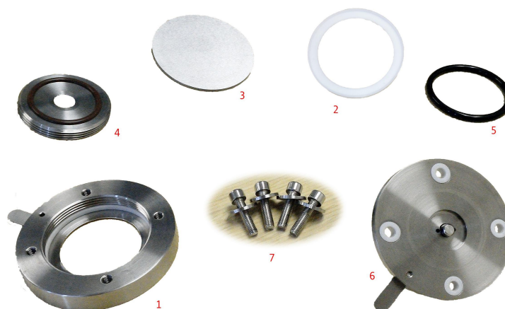
Figura 4.10: Celda con alojamiento para la ventana de berilio: 1)vista inferior de la base del electrodo de acero que aloja la batería y la ventana de berilio, 2)aro de teflón blanco, 3)ventana de berilio, 4)soporte para los electrodos de la batería, 5)o-ring de teflón negro, 6)contraelectrodo con sistema de inyección electrolítico, 7)tornillos de sujeción de cabeza hexagonal.
