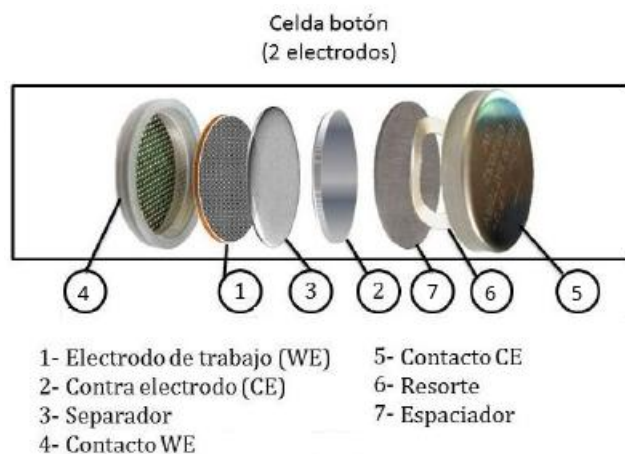
Figura 3.3: Esquema del interior de una celda electroquímica de dos electrodos (celda botón). Se señalan cada una de sus principales partes constituyentes [11].
