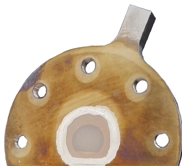
Figura 5.12: Primer mecanizado con ventana de kapton, metalizado de oro paladio y pintura de plata en la interfaz.
