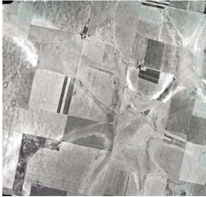
Figura 14. Fotografía aérea de red de drenaje tipo radial Fuente: Gorgas y Tassile, 2003
