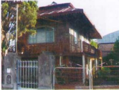
Casa Pérez Cornejo. (Casa Eiffel) San Vicente - Córdoba - Una de las tres casas prefabricadas de chapas de acero y vigas de hierro que ingresaron a la Argentina a comienzos del Siglo XX (1917) despachadas y embaladas por la compañía del Ingeniero Eiffel en Francia.
