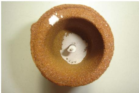
(a) Vista superior de un probetero para determinación del CE; en esta se observa el bifilar sobre el cual se monta la termocupla recubierta en cemento refractario mediante la cual se registra la temperatura.
