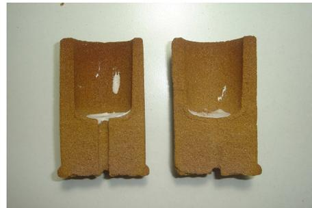
(b) Vista de un corte longitudinal sobre el plano medio de un probetero para determinación del CE.
