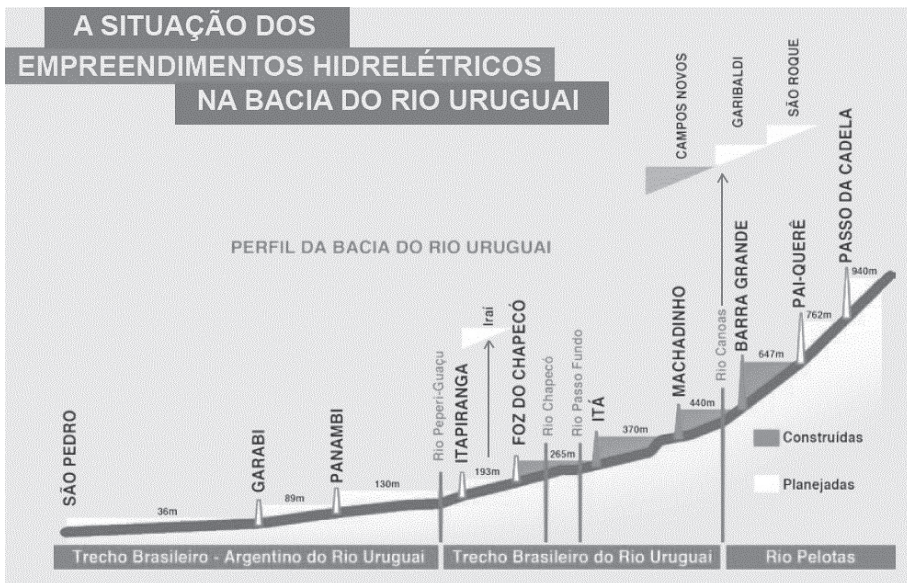
Figura 4: Perfil da bacia do rio Uruguai e seu aproveitamento hidrelétrico.
