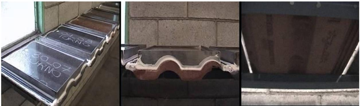
Figura 5: Tejas de hormigón durante el ensayo de permeabilidad
