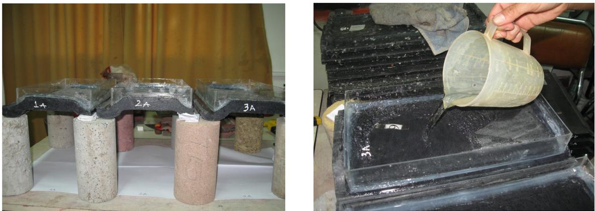
Figura 6: Tejas de material reciclado durante el ensayo de permeabilidad
