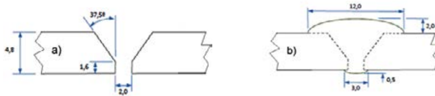
Figura 1: Esquema de la sección transversal del material base (a) y del cordón de soldadura sin defectos (b)
