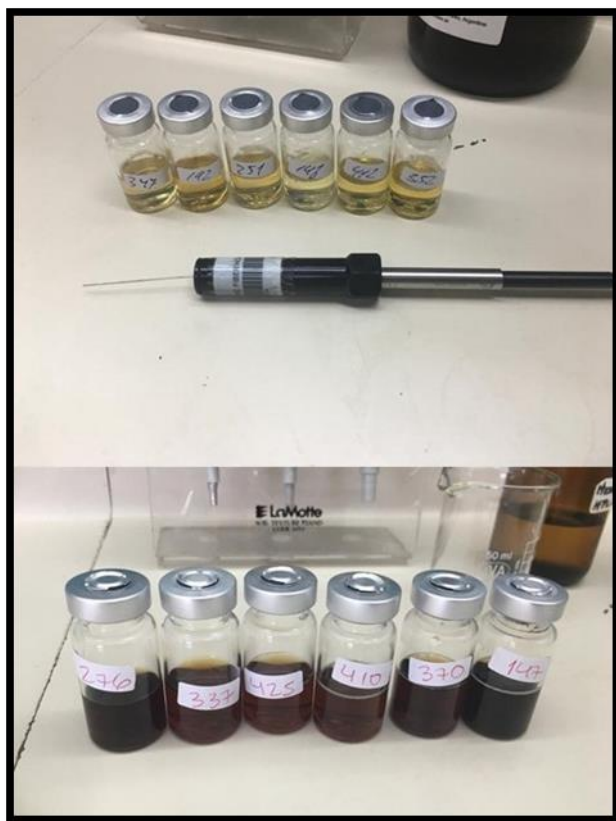
Figura 5: Imagen de viales sellados para la determinación de volátiles en cerveza rubia (imagen superior, donde también se ve una fibra de captura SPME para volátiles) y cerveza negra (imagen inferior) (Núcleo Cerveza – LabTA-FCA-UNC).
