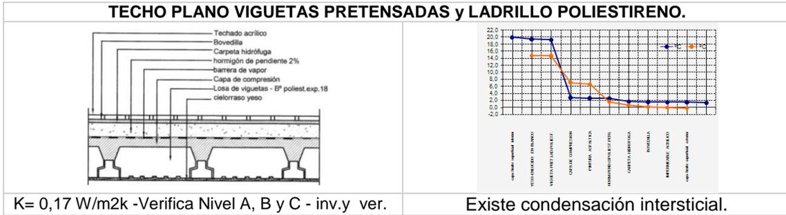
Fig. 8- Detalle constructivo y verificación riesgo de condensación en muro y cubierta
