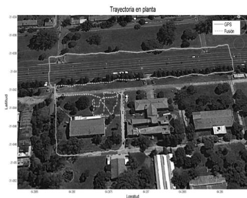
Figura 7: Trayectoria con fusión de datos y trayectoria con información GPS únicamente
