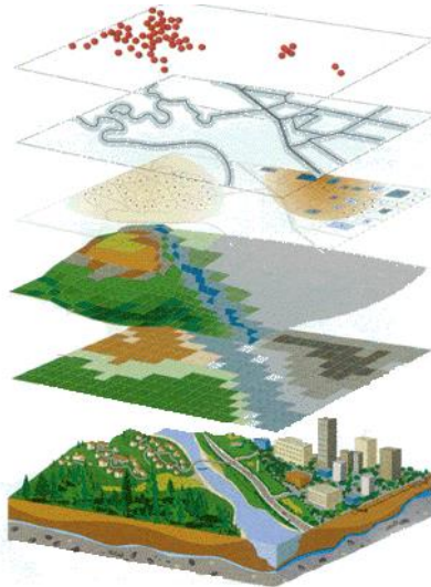
Figura 3.3. Capas temáticas, división vertical de un SIG.
