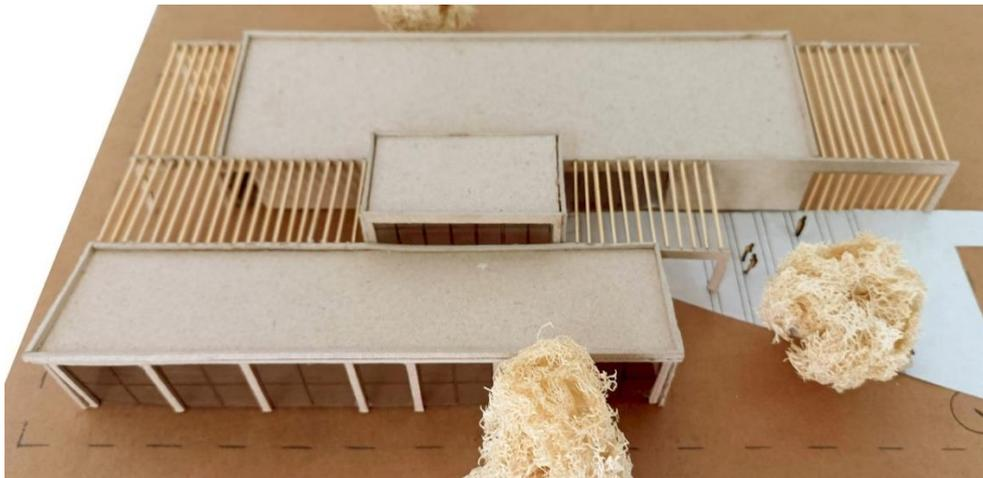
*Fig. 2. Maqueta vista superior. Se observan los tres volúmenes longitudinales del proyecto que se desplazan permitiendo los espacios de transición.*
