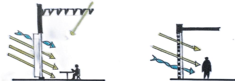
Figura 9. Materialidad expresada en corte. Izquierda el volumen de hormigón y derecha el de ladrillo, con sus posibilidades de iluminación.
