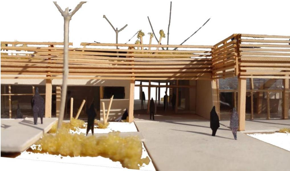
*Fig. 11: Maqueta 1.100. La estudiante explora la interacción de la estructura de hormigón visto con las envolventes. El orden del sistema estructural, se constituye en la expresión del edificio. A los pórticos de hormigón armado se anclan parasoles metálicos a modo de un plano continuo de elementos filares.*
