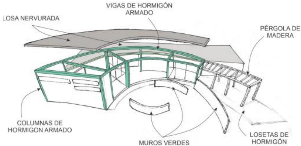
*Fig.15.Despiece axonométrico .
