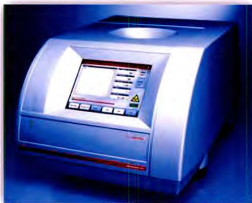
**Figura 2.5.** Reactor de microondas utilizado para las síntesis de 5-bencil-(tio)hidantoínas.
