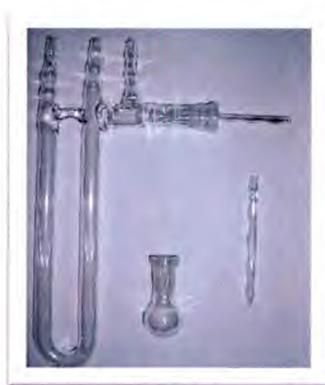
**Figura 3.1.** Trampa en forma de "U" para recolectar el pirolizado.
