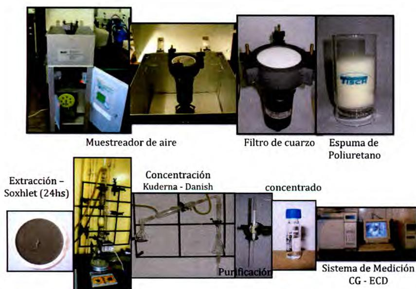
**Figura A.4.** Sistema de colección y tratamiento de muestras de aire.
