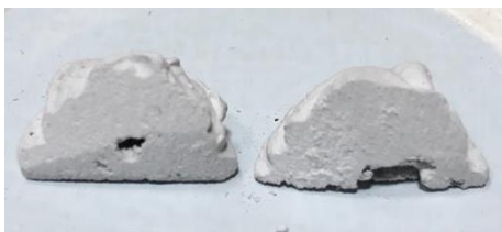
Ilustración 28: Piezas con 2 ml de agua desbastadas.
