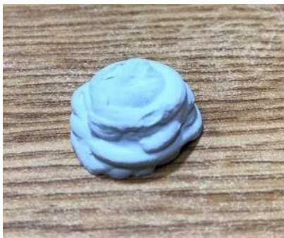
Ilustración 17. Pieza impresa con jeringa 3ml.
