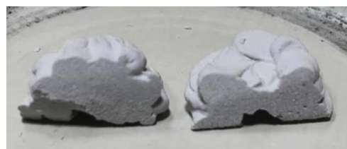
Ilustración 29: Piezas con 1,8ml de agua desbastadas.
