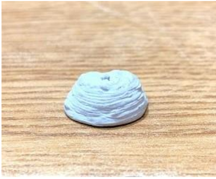
Ilustración 19. Pieza impresa con capuchón de aguja 21G.
