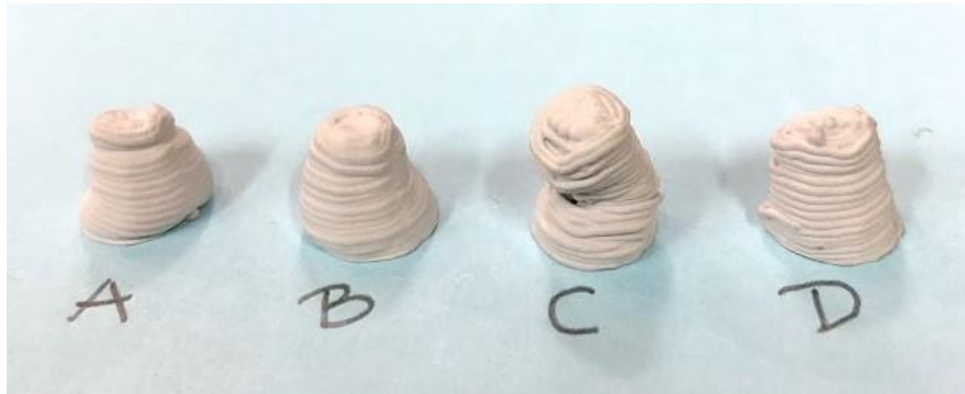
Ilustración 22. Cilindros de polvo de vidrio, vista lateral.
