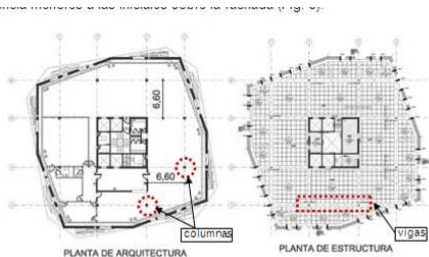
Fig. 5 - Ajuste en la planta original con la incorporación de columnas metálicas
