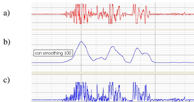
**Figura 2.** Suavizado de señal EMG rectificada (b)
