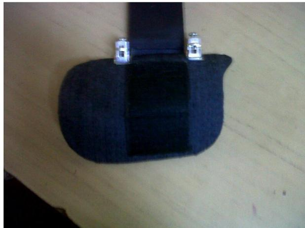
**Figura 6.** Dispositivo de fijación del exoesqueleto al hombro
