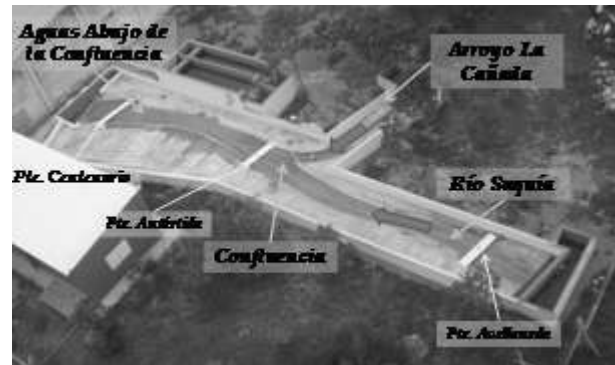
Figura 1.- Modelo Físico Tridimensional Río Suquía y Arroyo La Cañada.
