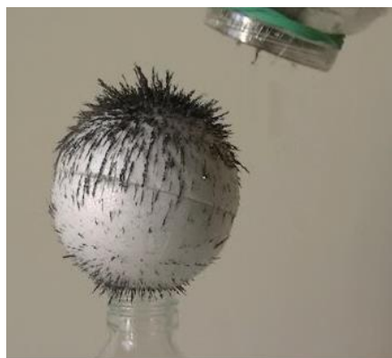
Figura 13: Se rocía limadura de hierro sobre la bola de telgopor que en su interior tiene un imán para mostrar las líneas de campo magnético que se forman en una esfera. Simulando las líneas terrestres
