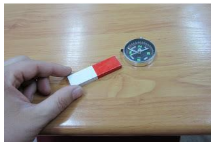
Figura 9: Se observa cómo se mueve la aguja de la brújula con el imán
