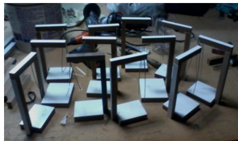
Figura 16: Soportes donde se colocaron los imanes. Se los sostenía de los alambres colgantes, así podían moverse sin dificultad
