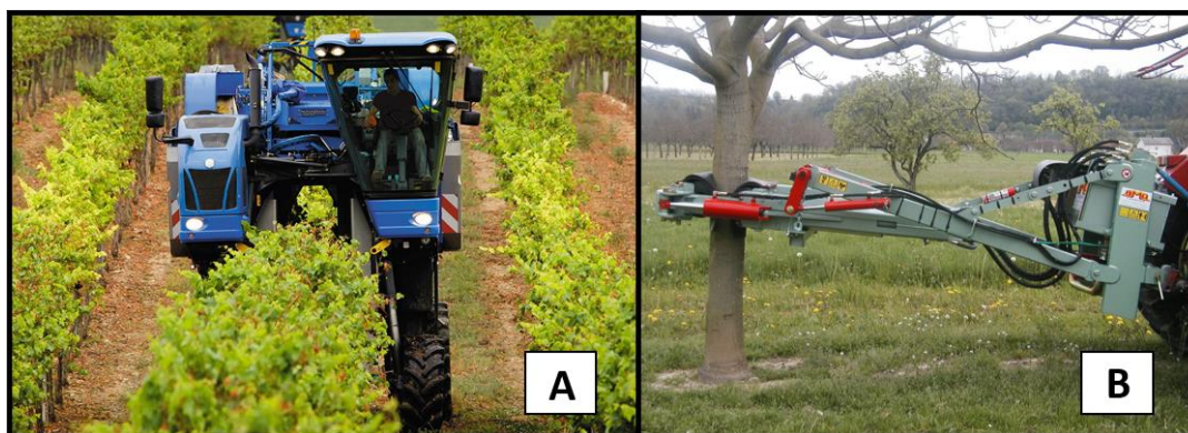
Fig. 1: Máquina cosechadora cabalgante en vid (A) y Máquina vibradora para frutos secos (B).
