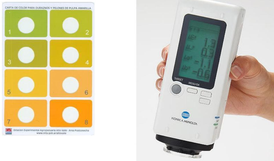
Fig.9. Carta de colores (A) y colorímetro (B) para evaluar el color de los frutos.
