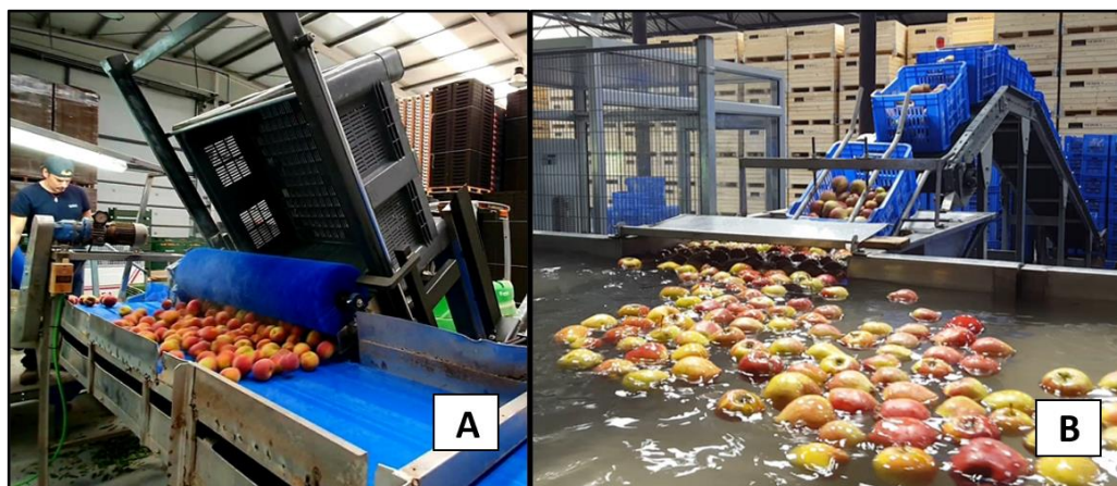
Fig. 8: A) Frutos de durazno cayendo en seco desde el bins a la cinta transportadora. B) bins con manzanas siendo vaciados por inmersión en agua.
