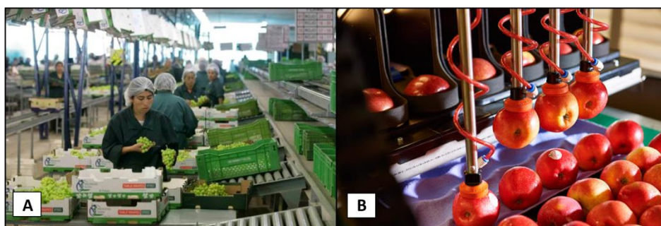
Fig. 12: Embalaje manual de uvas de mesa (A) y embalaje mecánico de manzanas (B).
