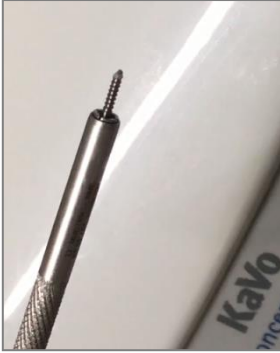
Figura 16. Grupo III, muestra 2 con fractura en su punta activa.
