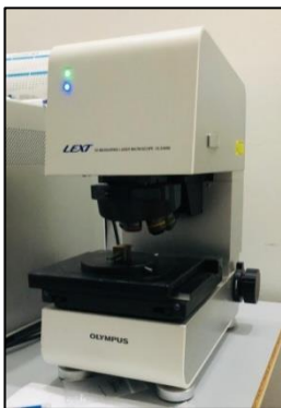
Figura 4. Fotografía del microscopio Confocal de barrido Láser OLYMPUS LEXT OLS 3000 presente en Laboratorio LAMARX.
