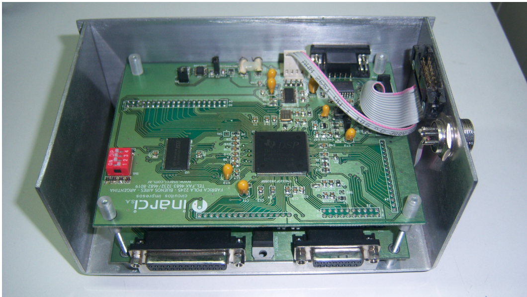
Figura 7.13: Fotografía del controlador completo construido, donde se observa en detalle el DSC.
