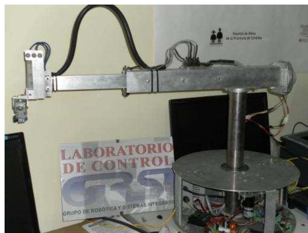
Figura 1: Brazo Laparoscópico desarrollado en el GRSI. En el extremo del brazo, está montado el sensor háptico (Fig. (2))
