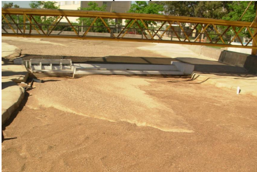
Figura4.- Barra de sedimentos aguas debajo del foso de erosión, ensayo N°1 900m 3 /s.
