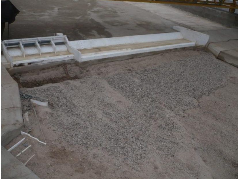
Figura3.- Acorazamiento con diámetro medio de 8mm y máximo de 12mm.
