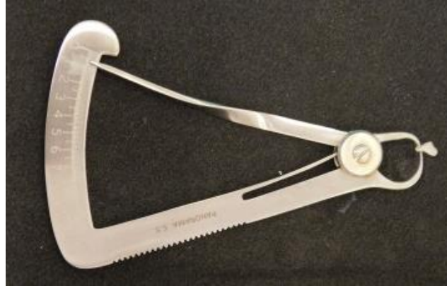
Fig. 18. Medición de espesores.
