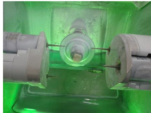
Fig. 15. Fresado de las restauraciones
