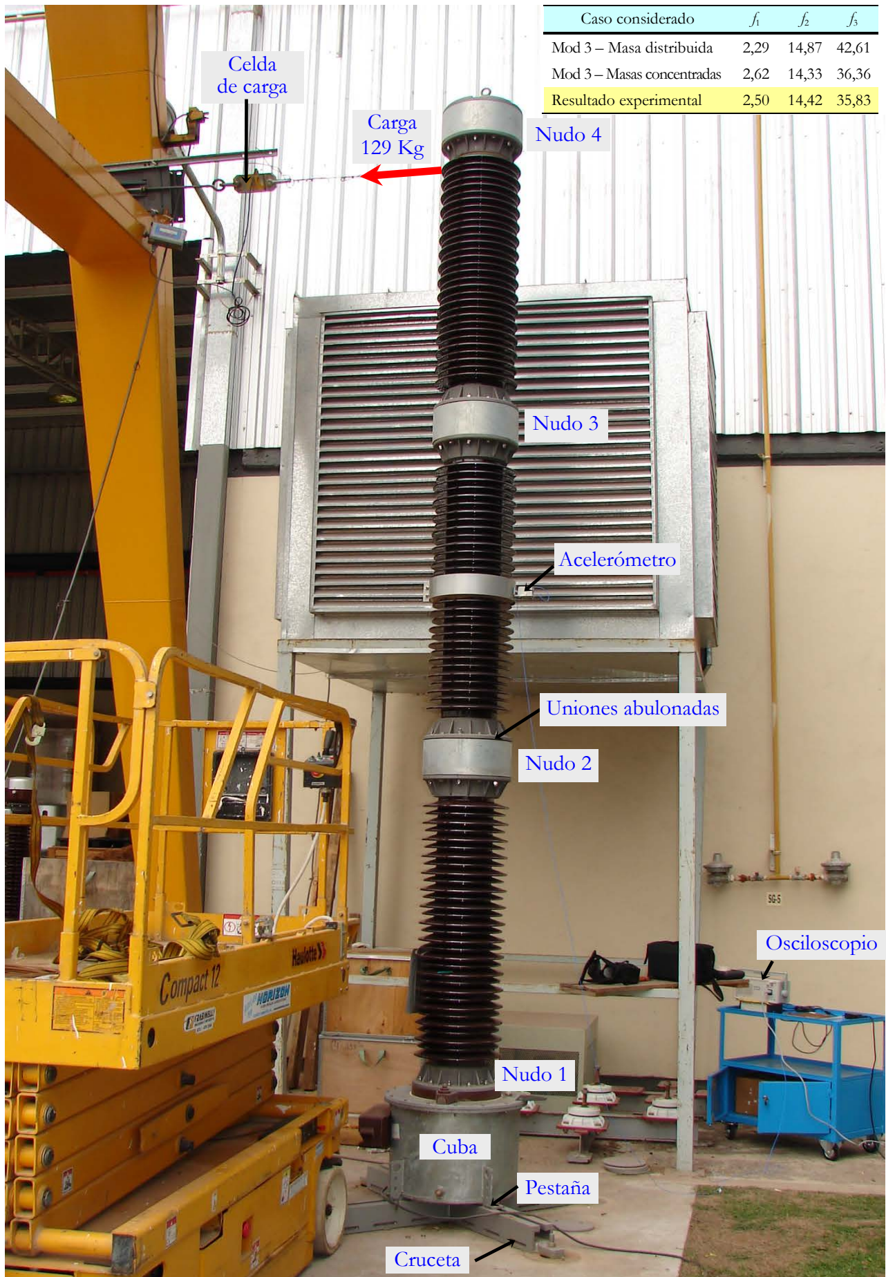
Figura 8: Disposición del transformador en el ensayo de oscilaciones libres.
