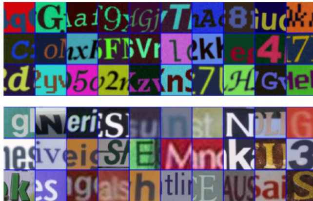
Figura 8: Arriba se puede ver el conjunto de imágenes sintéticas creadas por Wang et. al. Estas imágenes tienen una dimensión de 48x48 píxeles e intentan imitar a las imágenes reales. Abajo se puede observar un conjunto de imágenes reales recortadas que fueron extraídas del dataset ICDAR. Fuente: Wang et. al. [1].
