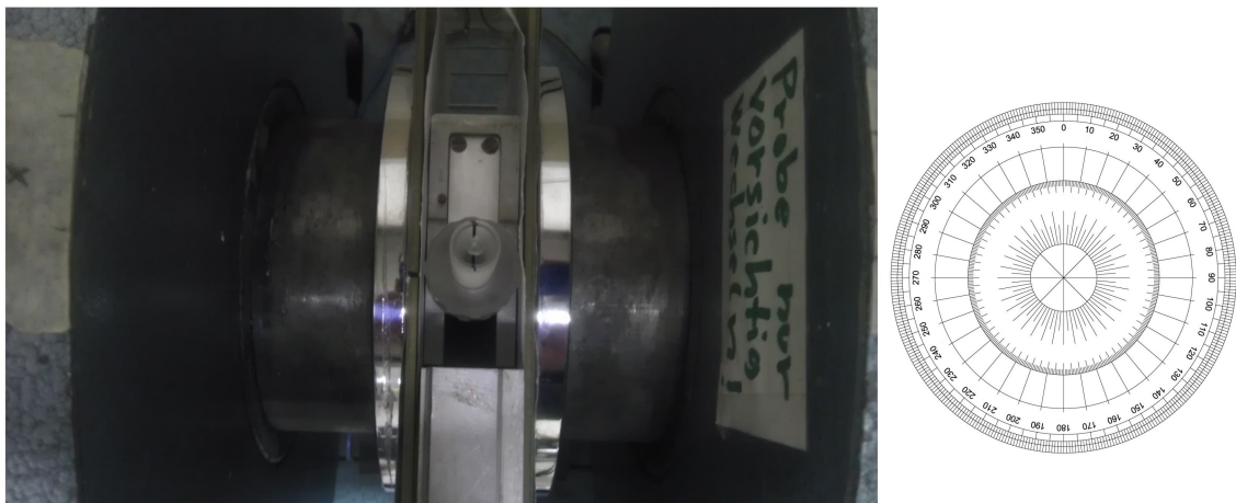
Figura 18: Vista superior del electroimán junto con el portamuestra (izquierda). Sistema de referencia angular utilizado (derecha).
