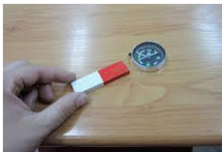
Figura 4: esquema experiencia 1. Se ve en la imagen una brújula a la que se le acerca un imán.
