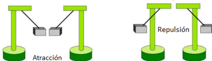
Figura 2: esquema experiencia 2. Se ve en la imagen dos pies de los que cuelgan imanes. Que se acercan o alejan dependiendo del modo en el que están orientados.
