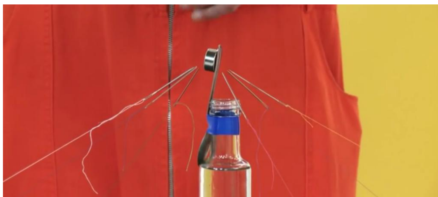
Figura 10: esquema experiencia 4. Se puede observar un imán sobre una botella con agujas suspendidas orientándose según el campo magnético.
