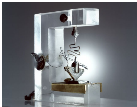
Figura 2.1: Primer transistor. (Cortesía de Lucent Technologies Bell Labs, Murray Hill, New Jersey)
