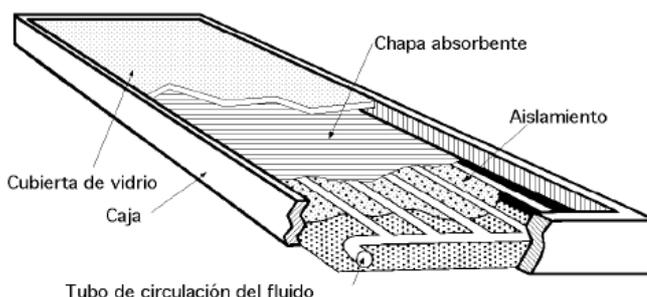
Figura 25. Esquema de un colector solar de placa plana. Adaptado de "Presentación de clases de Energía solar y fotovoltaica", por Barral, J. R., 2020.
