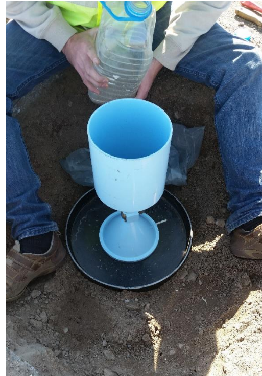
Figura 3-6. Ensayo Método de Arena en pista.
