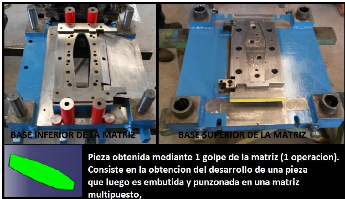
Figura 1.3: Matriz de Corte de Blank Proyecto Toyota Hilux
