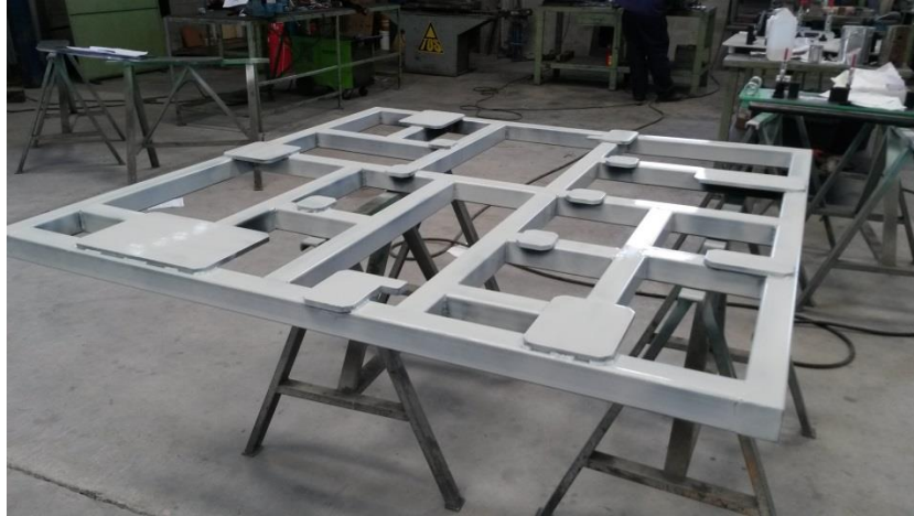
Figura 1.10: Estructura metálica soldada mediante soldadura MIG
