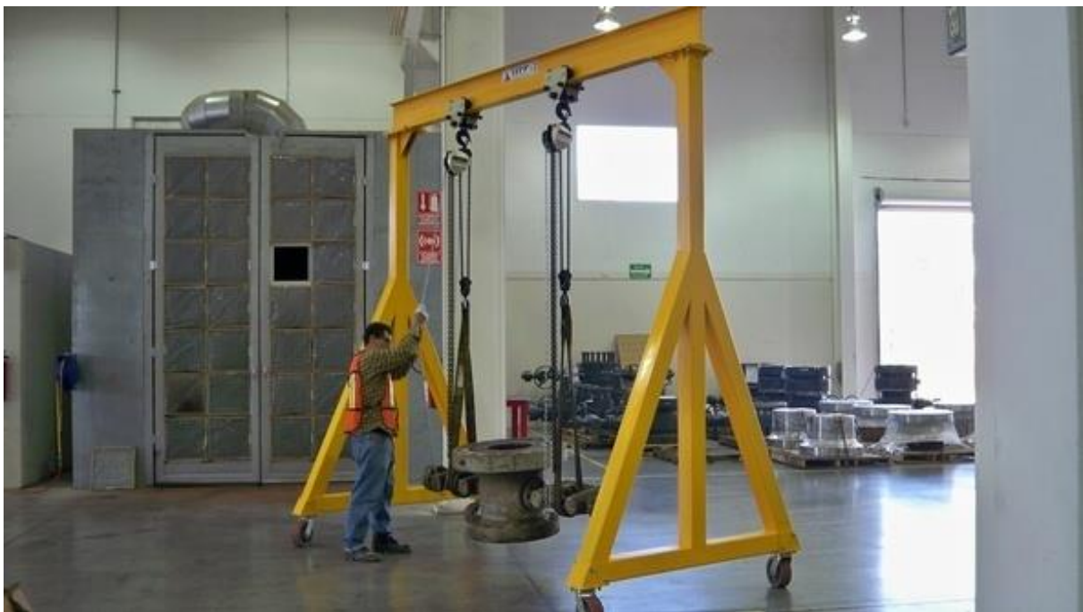
Figura 2.5: Pórtico de Izaje
