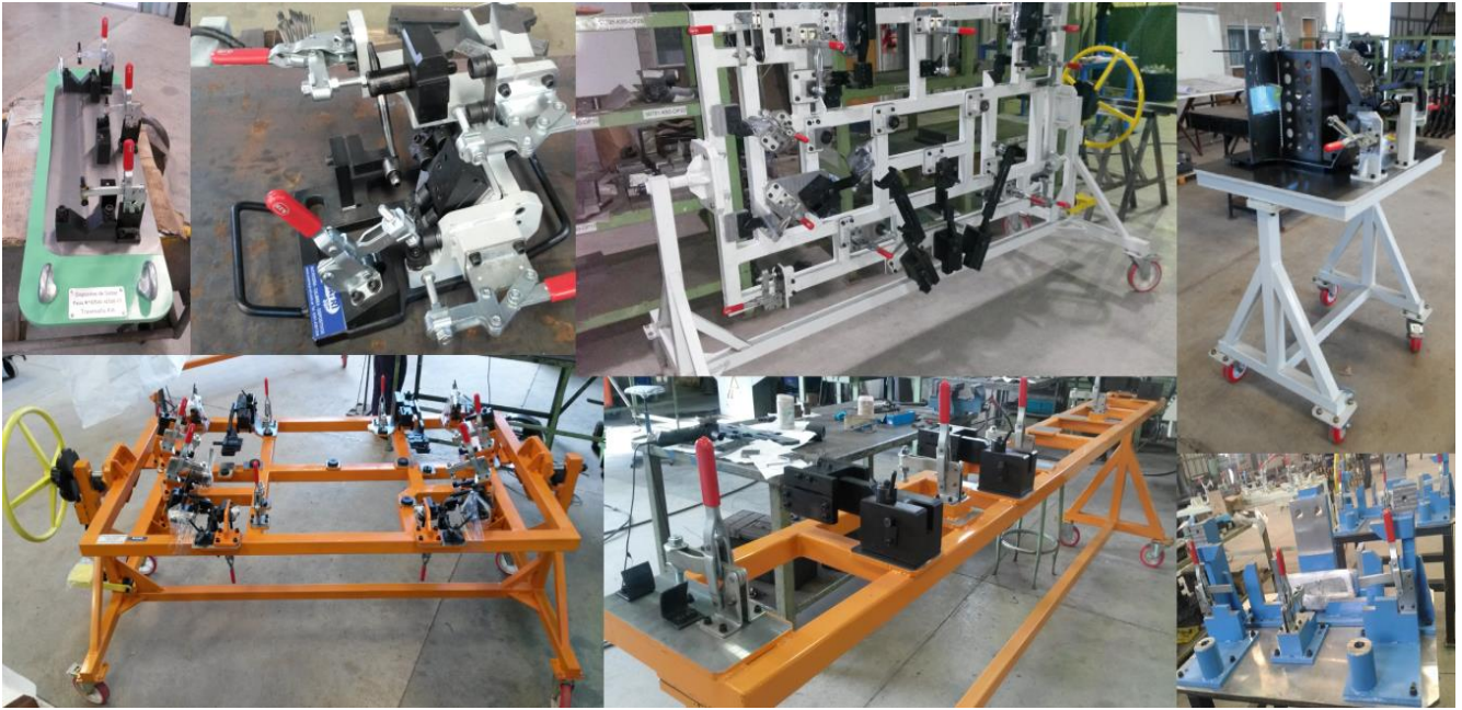
Figura 1.7: Dispositivos de montaje para la soldadura de piezas de la Agroindustria
